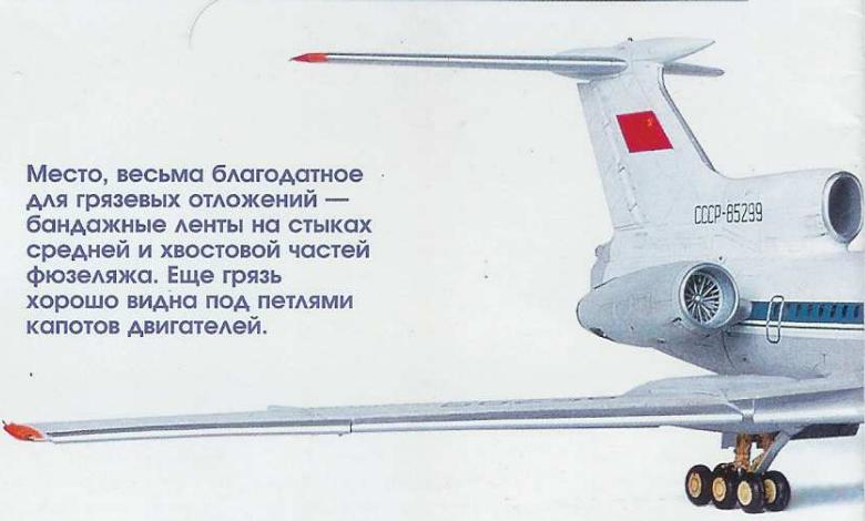
Место, весьма благодатное для грязевых отложений — бандажные ленты на стыках средней и хвостовой частей фюзеляжа. Еще грязь хорошо видна под петлями капотов двигателей.
