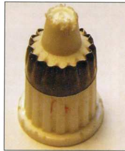
Лампы подсветки эмблемы на киле. О них мало кто знает, хотя их работу видел каждый, кто хоть раз был в аэропорту в темное время суток. На Ту-154 они упрятаны в пилоны двигателей.
