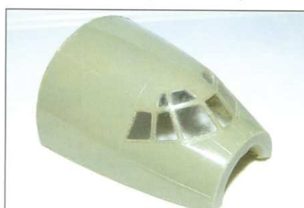
Слева и в центре: Изготовление окон с помощью гнутых полосок оргстекла и масок. Справа: Из-за особенностей материала модели верхнюю секцию фюзеляжа в районе пилотской кабины пришлось заменить копией из полиуретановой смолы. Стекла из миллиметрового оргстекла вставлены в вырезанные проемы и закреплены цианакрилатным клеем.
