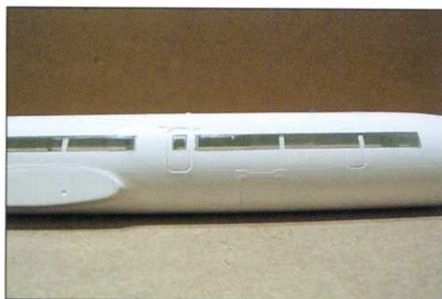
Слева и в центре: Изготовление окон с помощью гнутых полосок оргстекла и масок. Справа: Из-за особенностей материала модели верхнюю секцию фюзеляжа в районе пилотской кабины пришлось заменить копией из полиуретановой смолы. Стекла из миллиметрового оргстекла вставлены в вырезанные проемы и закреплены цианакрилатным клеем.
