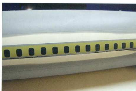
Слева и в центре: Изготовление окон с помощью гнутых полосок оргстекла и масок. Справа: Из-за особенностей материала модели верхнюю секцию фюзеляжа в районе пилотской кабины пришлось заменить копией из полиуретановой смолы. Стекла из миллиметрового оргстекла вставлены в вырезанные проемы и закреплены цианакрилатным клеем.
