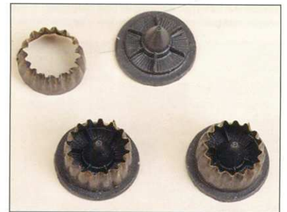
Лампы подсветки эмблемы на киле. О них мало кто знает, хотя их работу видел каждый, кто хоть раз был в аэропорту в темное время суток. На Ту-154 они упрятаны в пилоны двигателей.
