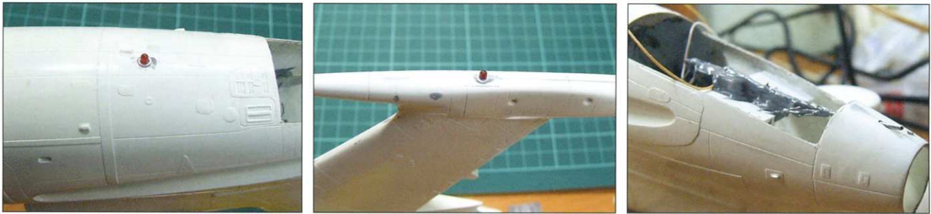
Слева и в центре: Красные светодиоды с линзой в виде штырька подошли без обработки. Справа: Белый хвостовой огонь из-за маленького размера пришлось имитировать световодом, вклеенным в светодиод.
