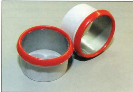
Изготовление входного устройства двигателя. Стаканчик канала воздухозаборника из бумаги, он же с приклеенной обечайкой воздухозаборника, все в сборе.
