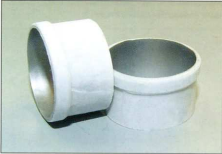
Изготовление входного устройства двигателя. Стаканчик канала воздухозаборника из бумаги, он же с приклеенной обечайкой воздухозаборника, все в сборе.
