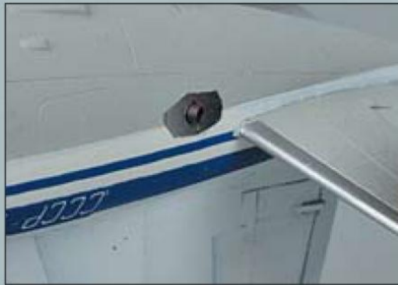
Слева: Передняя стойка шасси и фюзеляжная посадочная фара. В центре: Сопло ВСУ из кусочка отожженной стальной трубки. Справа: Основная стойка шасси.
