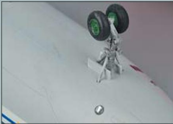
Слева: Передняя стойка шасси и фюзеляжная посадочная фара. В центре: Сопло ВСУ из кусочка отожженной стальной трубки. Справа: Основная стойка шасси.
