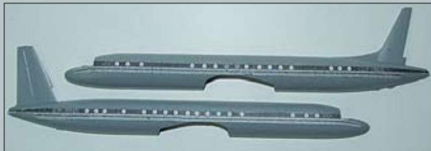
Слева: Распечатанный скан декали в качестве шаблона для засверливания окон. В центре: Просверленные окна изнутри надо рассверлить для получения тонких кромок.
