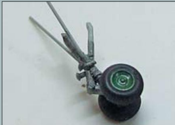
Слева: Воздухозаборники обдува генераторов гораздо лучше смотрятся, если сделать их пустотелыми с помощью бормашины. В центре: Новые подкосы и цилиндры демпферов делают стойку копийнее. Справа: Щели отлично заделываются циакриновым гелем с активатором.
