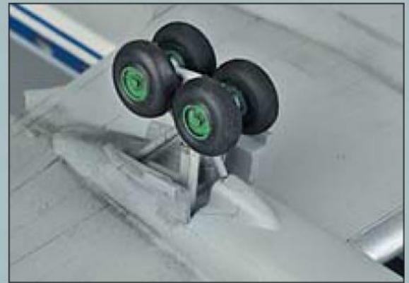
Слева: Передняя стойка шасси и фюзеляжная посадочная фара. В центре: Сопло ВСУ из кусочка отожженной стальной трубки. Справа: Основная стойка шасси.
