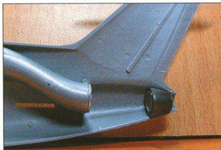
Слева: Установка S-образного канала и сопла второго двигателя. Центр: Воздухозаборник обдува генератора второго двигателя. Справа: Антенна УКВ
